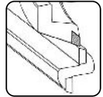
Заточка инструмента по задней поверхности
